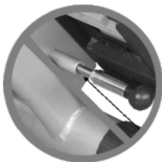
Sicherungs-Pin (34B) in gelöster Position
