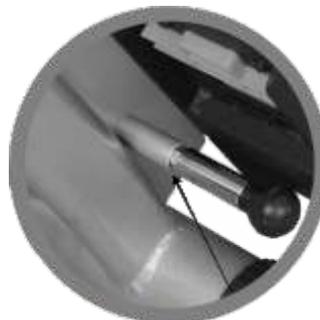
Sicherungs-Pin (34B) in eingerasteter Position
